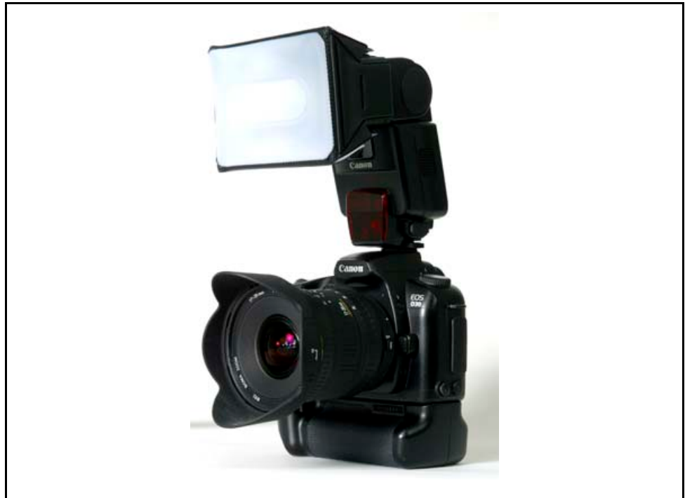
Abb. 32: Digitale Spiegelreflexkamera mit Aufsteckblitz und Diffusor
